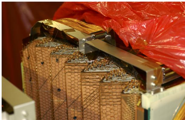
図 2.9: 電磁カロリメータの内部構造 [15]
