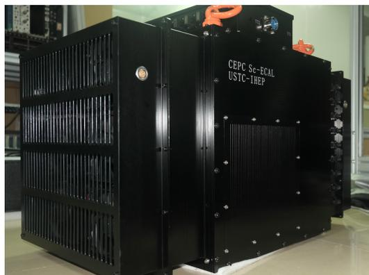
図 2.8 ScECAL 大型プロトタイプ
