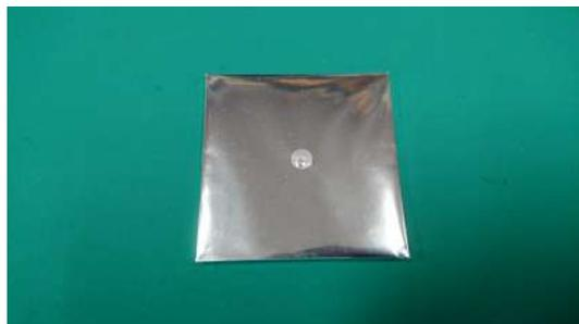
図 3.3 反射材を巻いた 60 mm 角タイル
