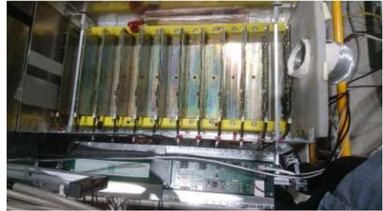
図 4.12 テイルキャッチャー。HBU1 枚を検出層、7.4 cm の鉄を吸収層として、12 層からなる。
