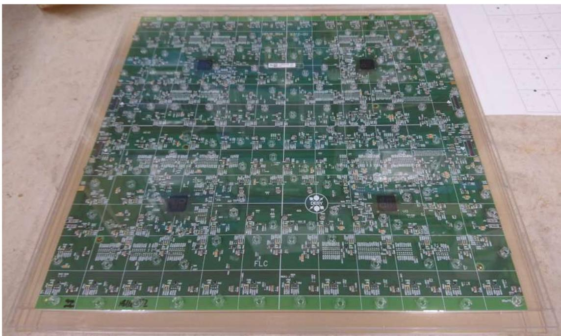
図 3.30 完成した 60 mm 角タイルを用いた HBU の表面
