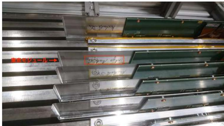
図 4.13 中央の Tokyo Module と書かれているのが、挿入された 60 mm 角タイルを用いた HBU(東京モジュール)
