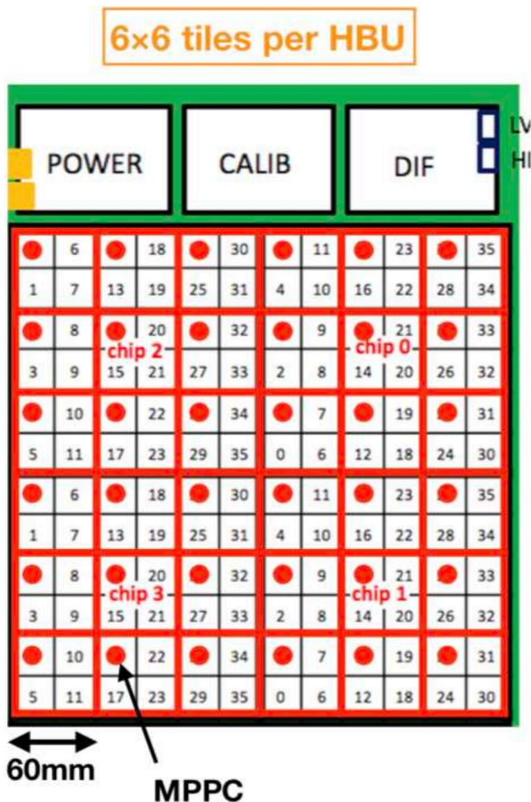
図 3.20 60 mm 角タイルを用いた HBU のデザイン
