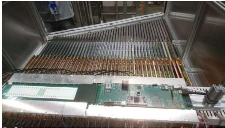
図 4.6 完成した大型試作機。検出層の HBU と鉄の吸収層がサンドイッチ状に配置されている。
