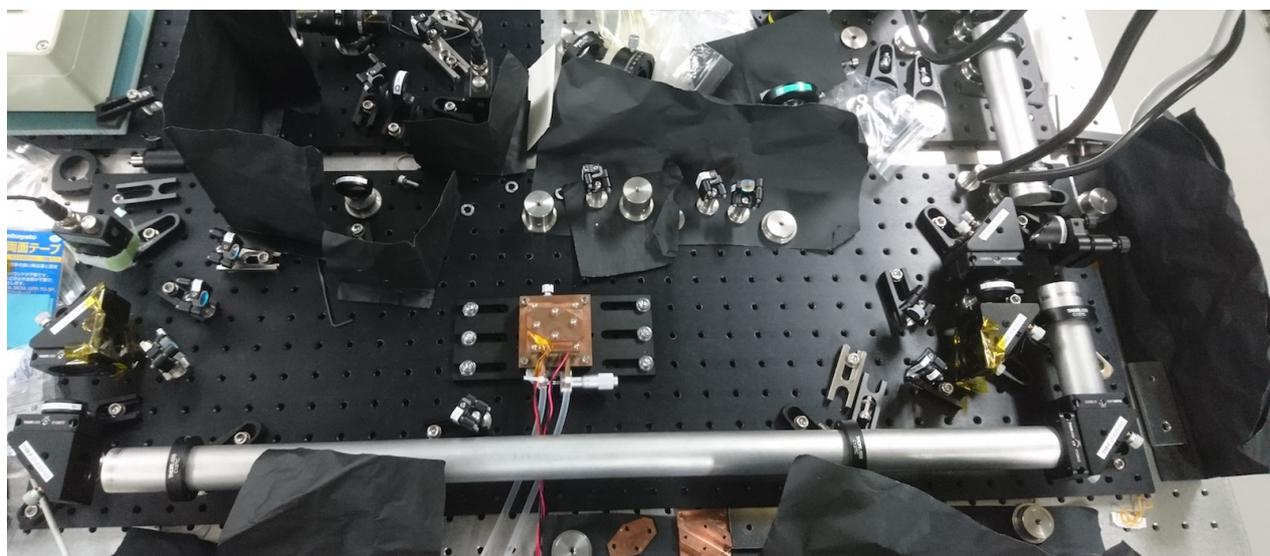
図 5.4 マルチパス増幅の光学系。写真の中央にある Ti:Sapphire 結晶に両側から 532 nm パルスレーザーを照射して励起する。729 nm パルスは今回は 2 回結晶を通過させている。
