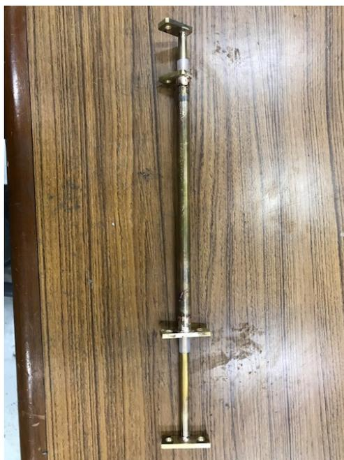
図 3.28: 電線の振動を避けるために作成した同軸ロッド。この同軸ロッドを用いて電極から磁石に電流を流す。芯線と外縁部はテフロンチューブで絶縁されている。同軸構造であることから電流が流れても同軸ロッドが振動することはない。
