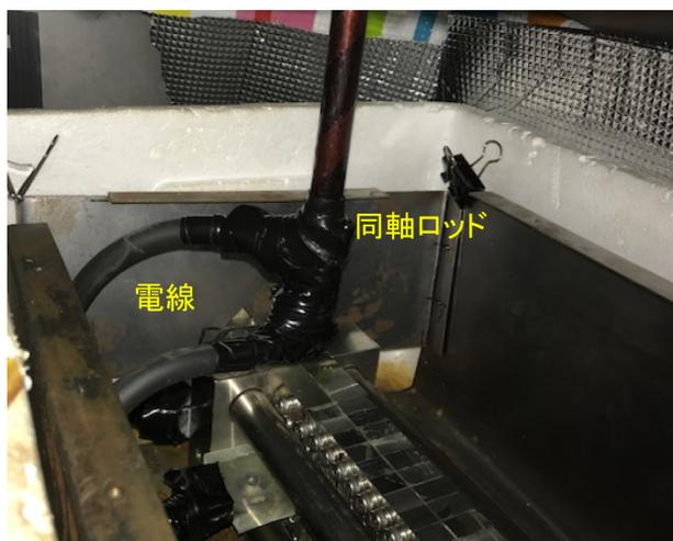
図 3.29: 同軸ロッドと磁石の接続。磁石から伸びている KIP 電線の長さを必要最低限の 10cm 程度にとどめ、以降は同軸ロッドで電極と接続される。
