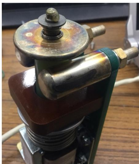
図 3.32: 充電制御に用いているメカニカルリレー。度重なる接点の開閉に伴う放電で焦げ付いているのがわかる。
