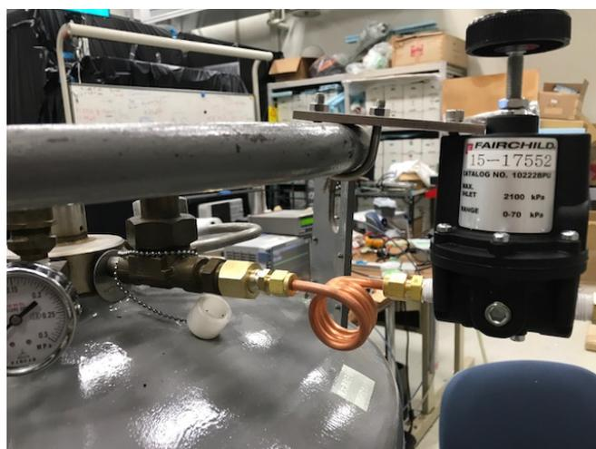
図 3.39: ジェック東理社製保圧弁。自加圧式セルファーの取り出し弁に取り付けることでセルファーの内圧を一定に保つ。内部圧力は0.07MPaの範囲で調整可能であり、本実験では0.03MPaで保圧した
