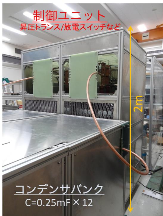
図 B.7: パルス磁石駆動用電源の写真。昇圧や充放電を切り替える制御ユニットと、電荷を蓄えるコンデンサバンクからなる。
