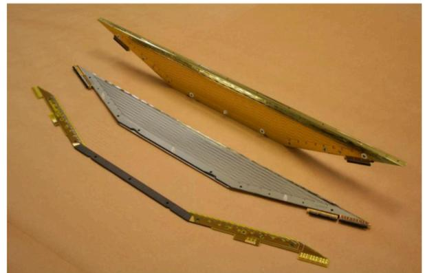
図 2.18 MEG 実験におけるドリフトチェンバーのモジュール
