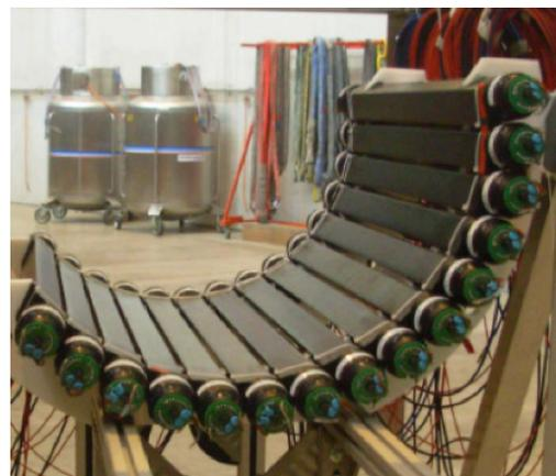
図 2.21 MEG 実験における陽電子タイミングカウンターの写真
