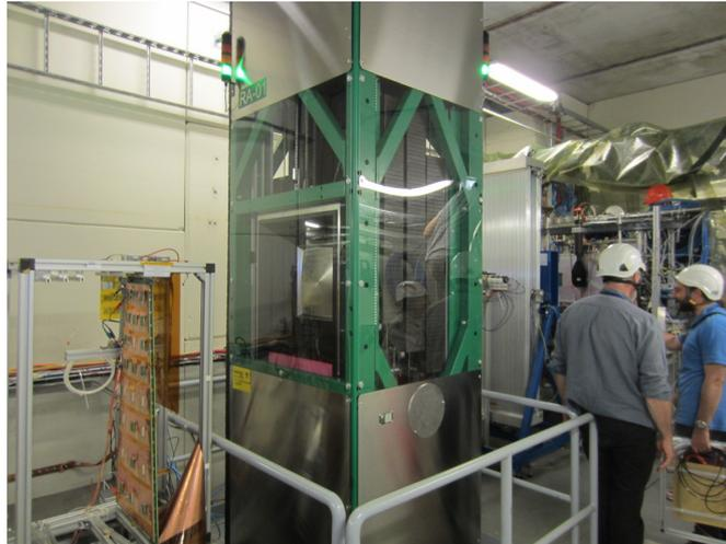
図 8.2 照射装置：この内部に  $^{137}\text{Cs}$  が格納されている。
