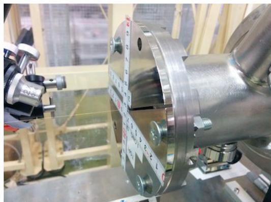
図 5.8 円盤のフランジへの取り付けの様子
