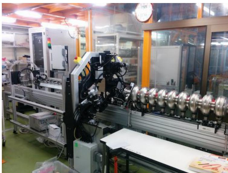
図 4.1 空洞チューニングマシン全体図：空洞チューニングマシンは外径測定器、ビーズ測定器、チューニング機構の 3 つで構成されている。それぞれの機構間をモーター駆動の移動架台によって行き来する。図は加速空洞を HOME と呼ばれる待機位置に置いてある様子である。写真中央のゲート部分が加速空洞を機械的に伸び縮みさせることで周波数及び加速空洞の軸を調整するチューニング機構である。また、ビーズ測定はこの位置でおこなう。加速空洞の外径測定器はゲートの奥にあり、ここで外径を測定し、各セルの機械的中心点の座標を測定する。
