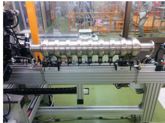
図 4.3 キャリブレーション用空洞模型：図はキャリブレーション用の空洞模型の実際の写真である。材質はステンレスである。この模型空洞は旋盤による削りだしによって製造されているため、中心軸の精度及び外径の精度は高いと考えられる。
