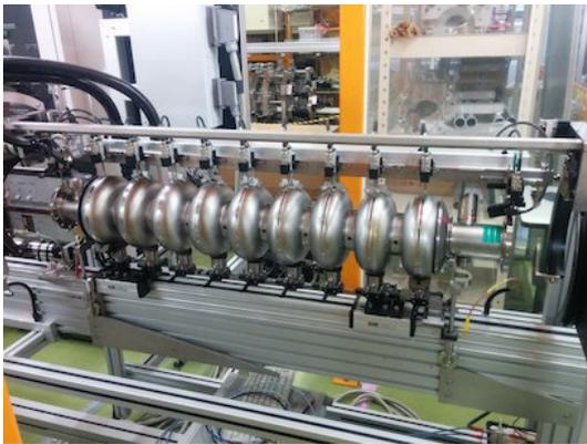
図 4.2 外径測定器の様子：図は外径測定中の様子である。空洞上方にあるバーが空洞の同心円上に移動し、バーに取り付けられたリニアゲージによって各角度でのバーと空洞表面との距離を測定することができる。それにより空洞の各セル、フランジの機械的中心点の位置を測定することが可能になっている。
