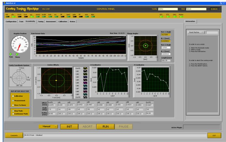
図 4.10 空洞模型の外径を測定したときのデータ例：キャリブレーション用の空洞模型を測定した様子である。画面上の波形がリニアゲージのある角度における伸びの量を表している。それぞれの波形は色によって何番目のセルまたはフランジであるかわかるようになっている。この波形から各セル、フランジにおける機械的中心位置が算出される。このとき、座標原点は過去のとあるキャリブレーション時の模型空洞の各セル、フランジの中心点の位置となっている。このときの  $xy$  座標系での各セル、フランジの座標を示したものが右下の 2 つのグラフである。また、左下のグラフはビーム軸方向に見たときの各中心点の位置をプロットしたものである。この測定は空洞模型のもので、それぞれの中心点は座標原点に密集していることがわかる。
