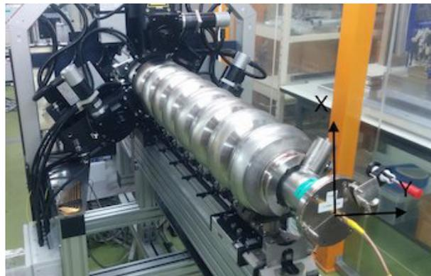
図 4.9 座標系の定義：座標系は図のように取っている。一般には 1 セル目は上流側のセルを指すが、チューニングマシンでは仕様により下流側セルを 1 セルと定義していることに注意する。そのため、他の測定と比較するために、生データ以外の表示では上流側を 1 セルに変換している。
