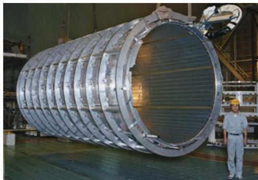
図 3.18: Solenoid Magnet の写真.
