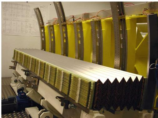
図 3.6: EM Calorimeter の写真. アコーディオン状になっており, Electron や Photon が Pb と衝突しやすくしている.
