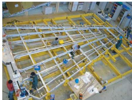
図 6.4: 水平状態での組み立て
