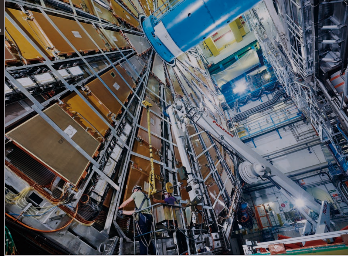
ATLAS検出器。全長46m、直径25m、重さ7000トンもある巨大な装置で、1億チャンネルものセンサーが組み込まれている。写真は第3期運用が始まる直前の様子。
