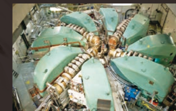
陽子サイクロトロン 世界最大強度の \mu 粒子ビームを生み出す PSIの陽子加速器。
