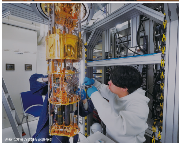
希釈冷凍機の複雑な配線作業
