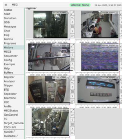
写真 5：ウェブブラウザによって実験施設内や検出器の状態が、共同研究者に24時間可視化されている。
