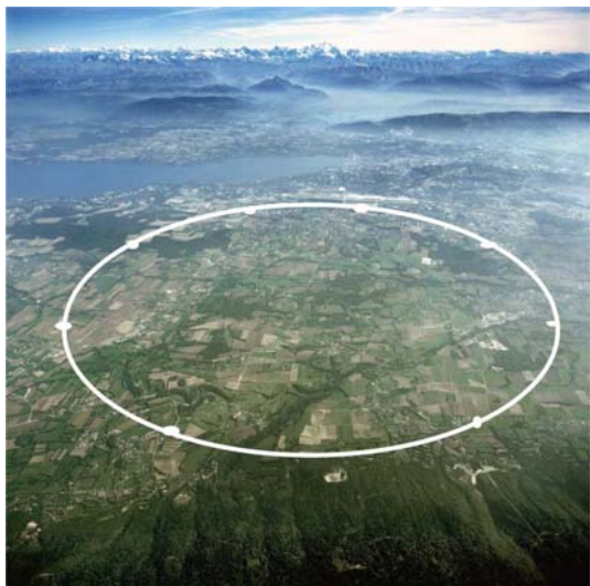
図 1. LHC 加速器が建設されている CERN の航空写真。地下 100m に周長 27km の加速器が設置されている。(写真提供 CERN)
