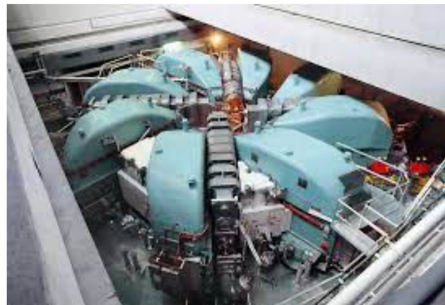
1.4 MW 590 MeV proton accelerator
