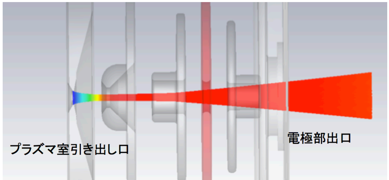
図 4.126: 電極部のビーム軌道計算結果 (CN=0 %)
