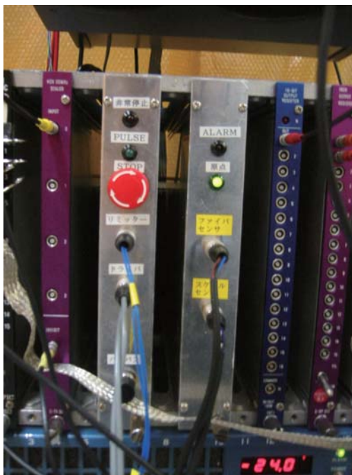
図 3.20: パルサーおよびエンコーダの写真。左:パルサー、右:エンコーダ
