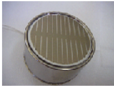
図 2.10: MEG 実験で用いられる光電子増倍管 (R9869)。光電面にアルミストリップを取りつけることで低温中での面抵抗の上昇を防ぎ高い量子効率が維持される。
