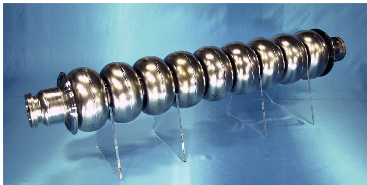
図 2.4: ICHIRO 空洞。51MV/m を目標としている。
