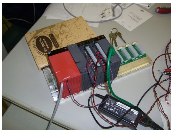
図 5.16: PLC (Programmable Logic Controller)。左から電源ユニット、CPU ユニット、ADC ユニット、DAC ユニット、Ethernet ユニットである。
