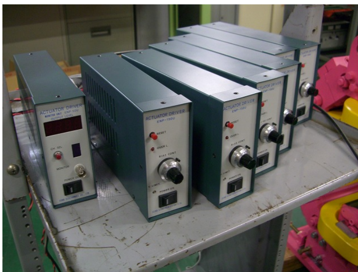
図 5.13: 電歪素子駆動用電源（直流増幅器）。左端は電圧モニターである。
