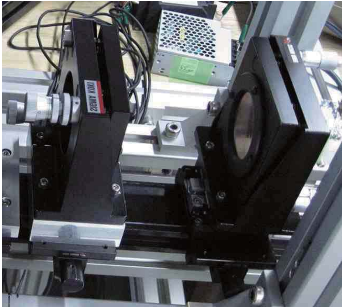
図 2.21: Fabry-Pérot Cavity の性能試験.
