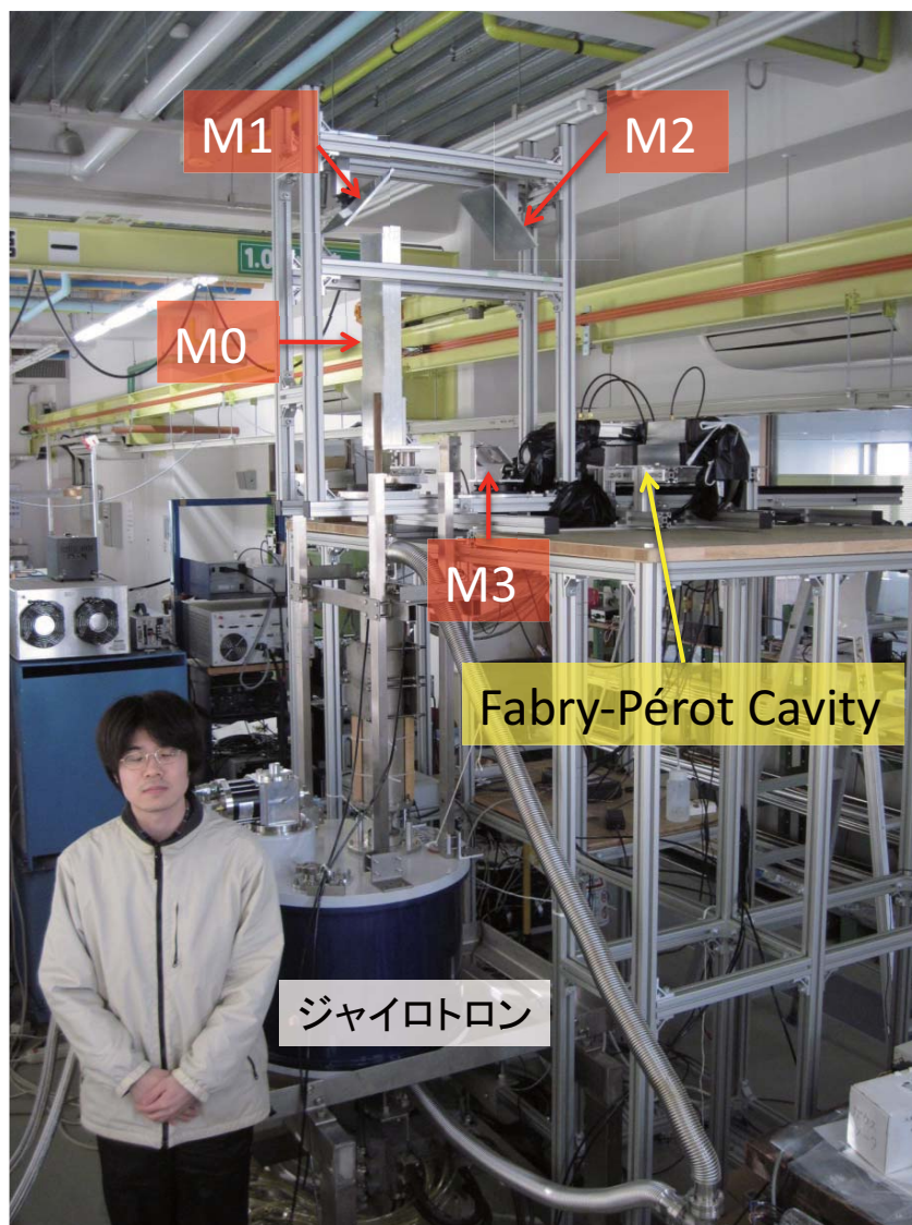
図 2.2: 光学系の全体写真. 手前にある青い超伝導コイルのなかにジャイロトロンが設置されている. その上部にあるのがビーム伝送系である. 画面右のガスチェンバーの中に Fabry-Pérot Cavityが入っている.
