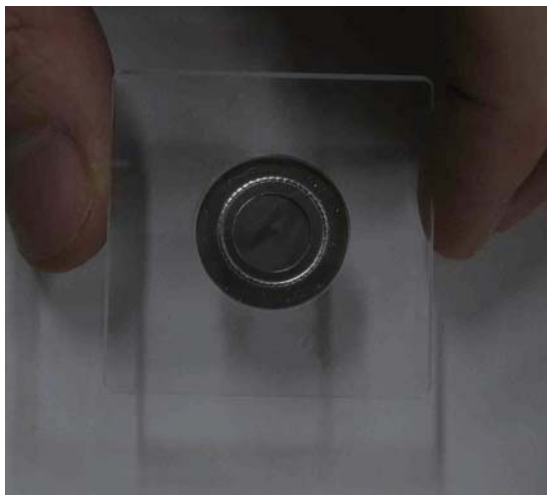
図 3.3: Ti パッケージ ^{22}\text{Na} とソースホルダ
