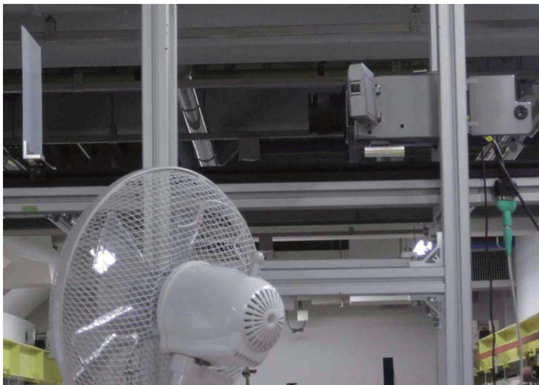
図 2.44: 塩化ビニル板によるパワー測定
