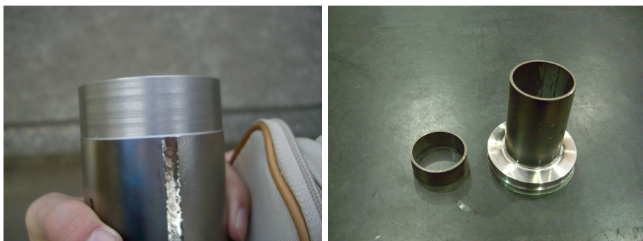
図 3.12: フランジ取り付け用のチタンの溶接
