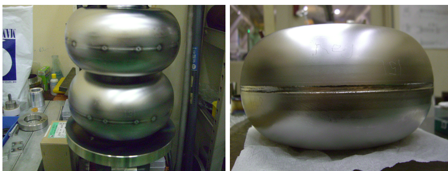
図 3.8: 点付け 本付けの様子
