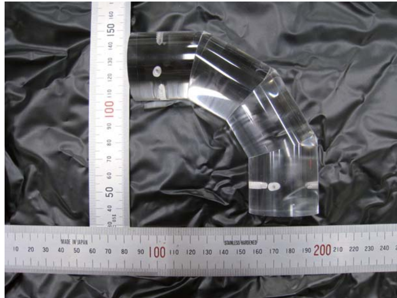
図 3.22: ライトガイド。LaBr 3 (Ce) や PMT との接着を確保するライトガイドホルダーのためのタップ穴が空いている。
