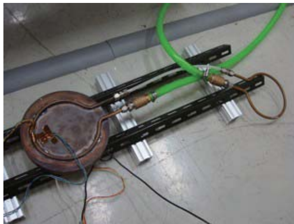
図 5.16: バルク銅を用いた冷却実験
