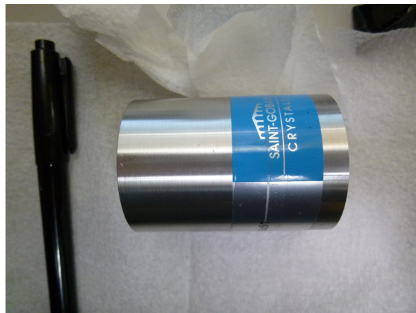
図 2.8: LaBr 3 (Ce) シンチレータ (Saint-Gobain B380)
