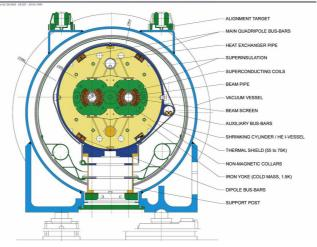
LHC DIPOLE : STANDARD CROSS-SECTION
