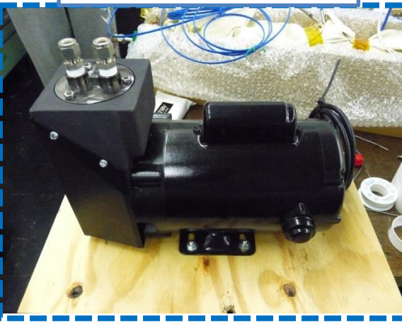
ガス循環ポンプ
