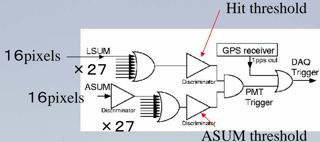
LSUM threshold を超えた logic 信号のsumが Hit threshold を超えた時、かつ、アナログ信号の 16pixel 分のsumが ASUM threshold を超えた時に DAQ のトリガーがかかるようになっている。
