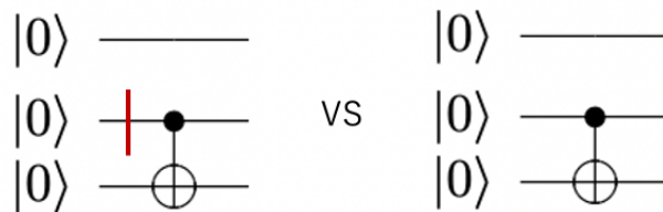
図 6.2 測定エラーの例。赤線で測定位置を示した。
