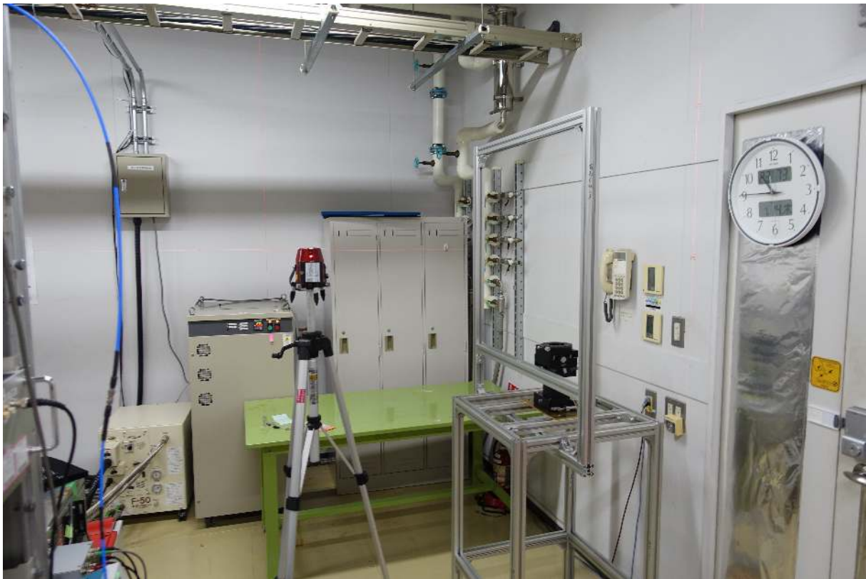
図 3.2.1: レーザー墨出し器による調整の様子。目視で受信機のホーンアンテナと球面ミラーの中心が一致するように台を調節した。
