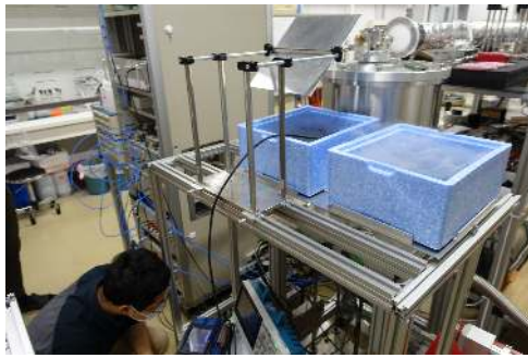
図 3.1.1: 77K 黒体のキャリブレーション測定
