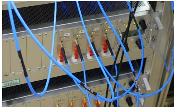
図 2.2.8: XFFTS に信号を導入している写真。LSBO,LSBI,USBI,USBO の 4 つの XFFTS を使用している。
