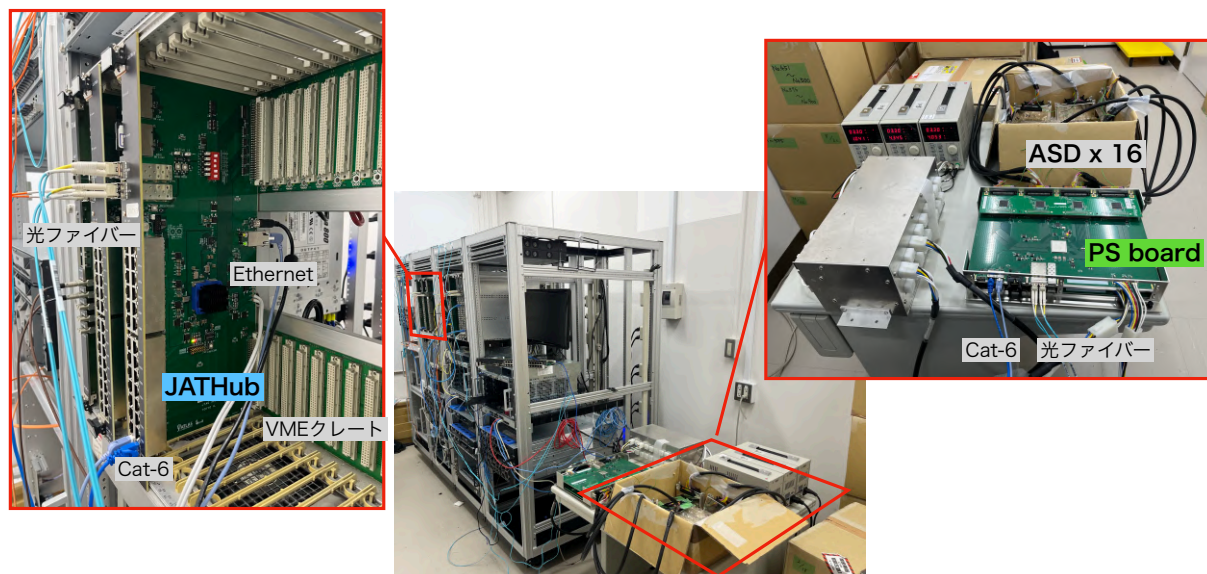
図 5.19 QAQC 試験のための東京大学でのセットアップ。QAQC 用 JATHub は VME クレートに設置し、バックプレーンの J3 コネクタを通じて給電する。PS board および ASD には 3.3 V デジタル、3.0 V、-3.0 V アナログ電源をそれぞれ用意し、デスクトップで給電する。QAQC 用 JATHub と PS board は 3 本の光ファイバーと 2 本の Cat-6 ケーブルで接続する。1 台の PS board には 8 台の ASD を接続する。
