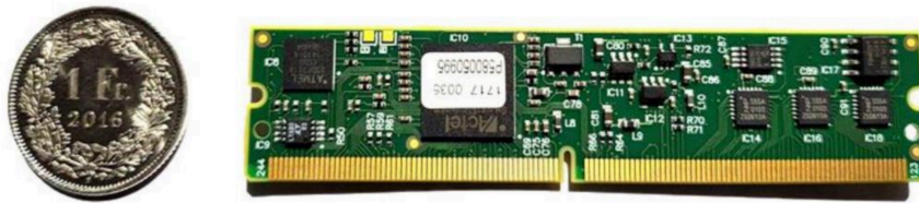
図 2.12: IPMC の写真 [19]。IPMC はボード上の温度センサーや電圧センサーの値をモニターし、ATCA shelf manager に報告する役割を果たす。
