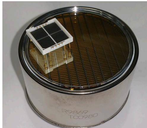
図 3.7 VUV-MPPC と PMT。γ 線入射面に PMT を使っていた頃と比べて細密な読み出しができるようになった。
