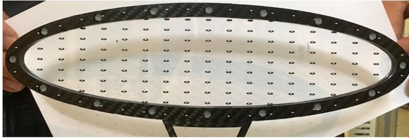
図 2.6 MEG II 実験での静止ターゲット [19]。位置評価用のマーカーが施されている。
