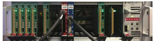
図 3.19: WaveDREAM のクレート。緑色の 7 個の WDB が挿入されている。最大で 16 個の WDB が設置可能。また、赤いボードが ancillary ボード、青いボードが TCB、右側に見えるのが CMB である。 [1]
