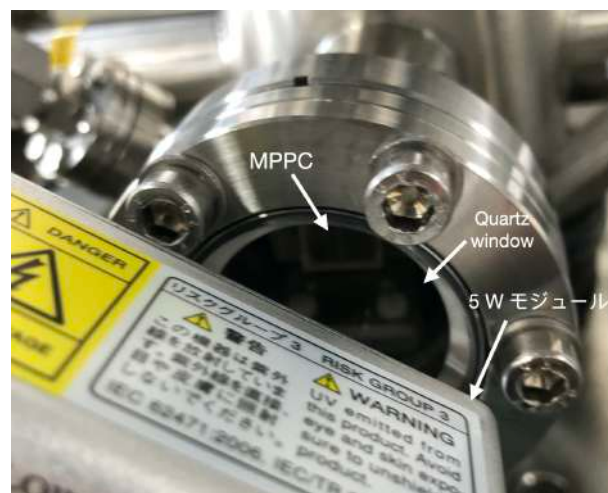
図 6.16: ランプ側からみたセットアップの写真。照射するときはこの周りをブラックシートで覆い、外部からの光を遮る。
