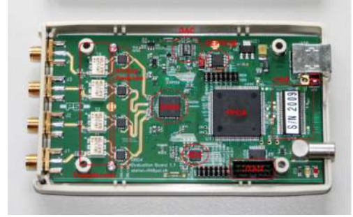
図 3.11: DRS4 評価ボードの写真 [13]
