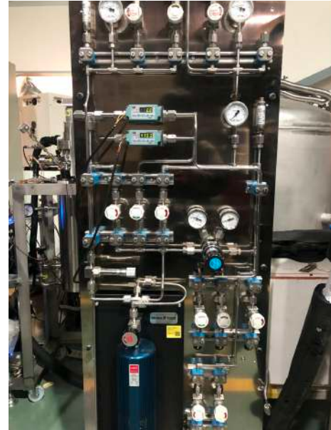
図 5.13: 液体キセノンの操作パネル。下部に見える青い円筒状のものがゲッターである。
