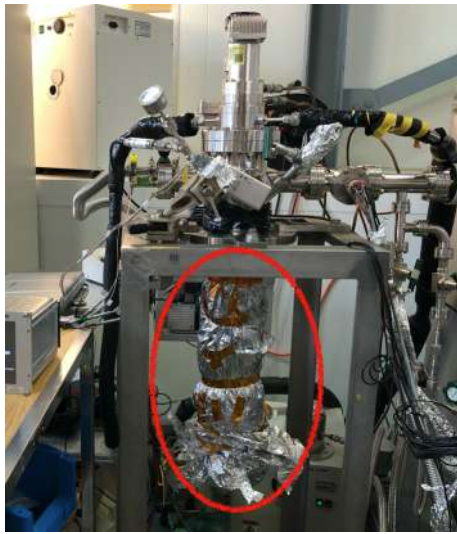
図 5.12: 液体キセノンを溜める真空容器の写真。図の赤丸部分には断熱材が巻かれている。その内部に真空容器が設置されており液体キセノンが満たされる。この周りにさらに外真空容器が装着される。
