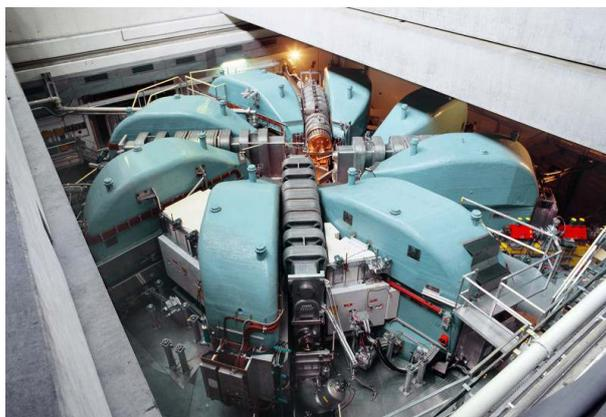
図 2.4: PSI 研究所の陽子加速器。リングサイクロトロンで、590 MeV まで加速することができる。
