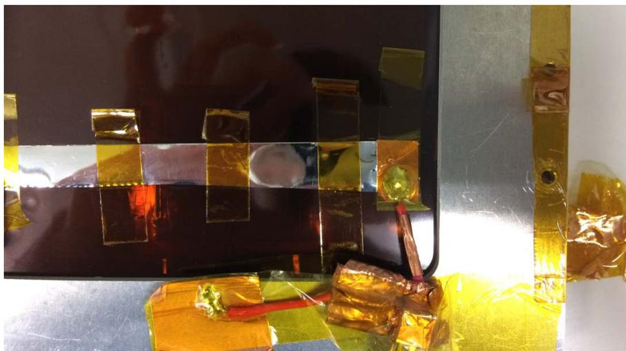
図 6.9: 読み出しの実装。アルミ蒸着カプトンを乗せている。100 nm のアルミに半田付けはできないため、導電性テープ (E13CE3020) を読み出しストリップの端に貼り付けた。
