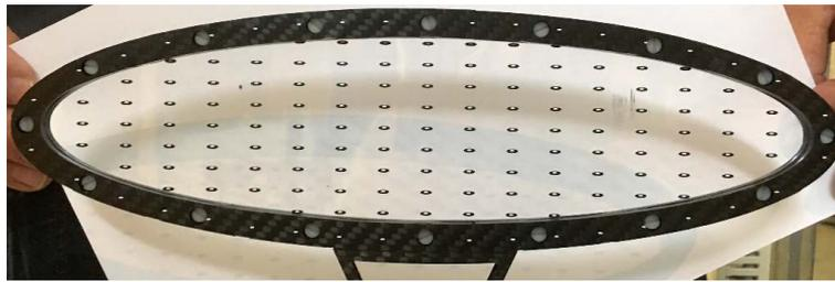
図 2.8: MEG II 実験で用いられるミュー粒子静止ターゲット [16]
