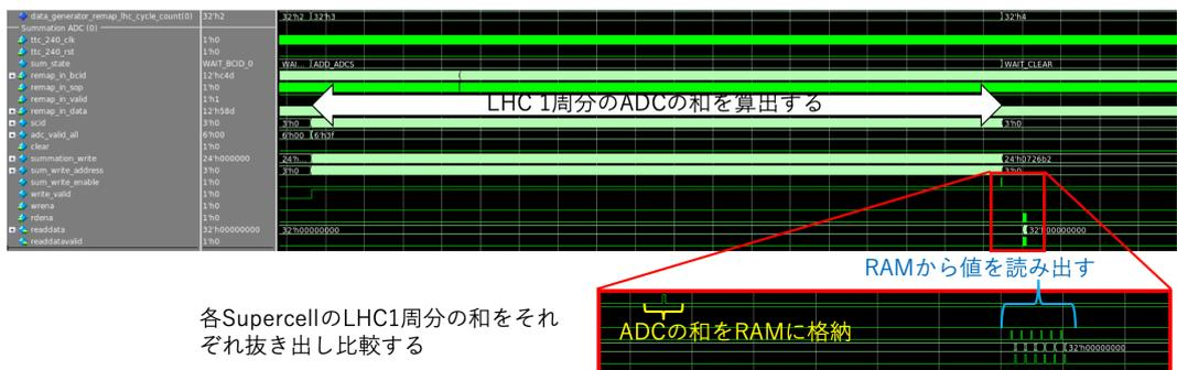
図 6.7: Summation ADC の Simulation による検証。計算された値は RAM に格納される (黄)。その後に IP bus を用いて読み出され、予測値と比較される。
