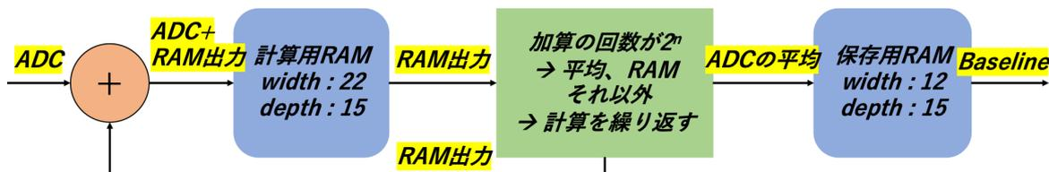
図 5.4: 最も単純な Baseline Correction の実装。ADC データを  $2^{10}$  回足し上げることから 1 つ目の RAM には  $12+10$  bit の width を用意する必要がある。1 度に全てのバンチ (12 bit)、Supercell (3 bit) に対し Baseline Shift を算出するので 15 bit のアドレスを用意する必要がある。
