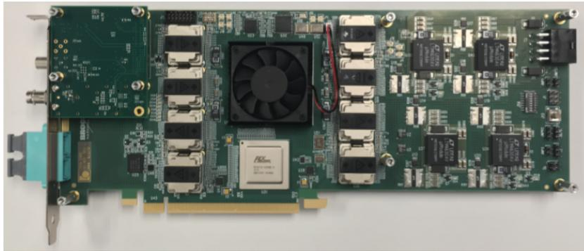
図 3.7: FELIX Board。XILINX Kintex UltraScale FPGA (XCKU115-FLVF-1924) を搭載し、MiniPOD を用いて 48 本の双方向高速通信を実現している。[16]
