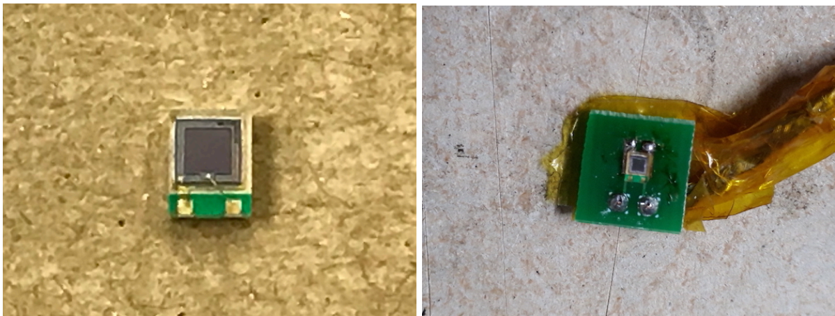
図 4.10: S12571-015P(左) と基盤に取り付けた様子 (右)
