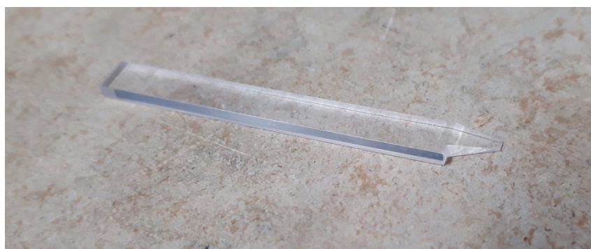
図 3.16: Bottom readout に使用するくさび形シンチレータ
