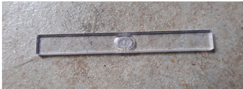
図 3.17: Dimple readout に使用するくぼみ付きのシンチレータ
