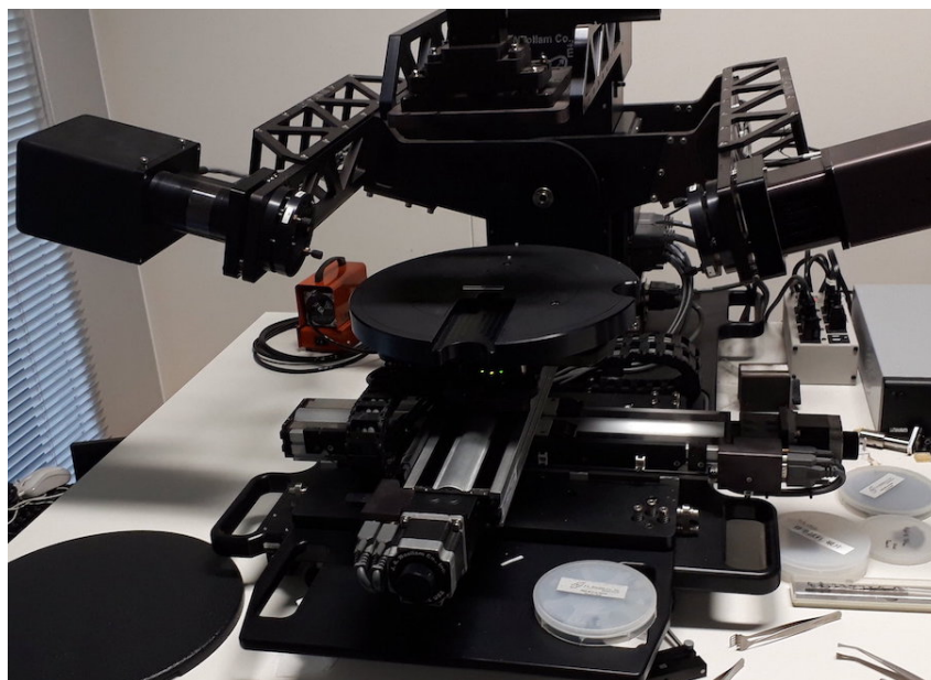
図 7.2: 屈折率の測定に使用した分光エリプソメータ (M-2000DI-T, J.A.Woollam)
