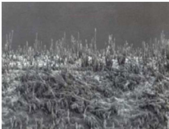
図 4.9 炭化水素の重合によって劣化したワイヤー[15]
