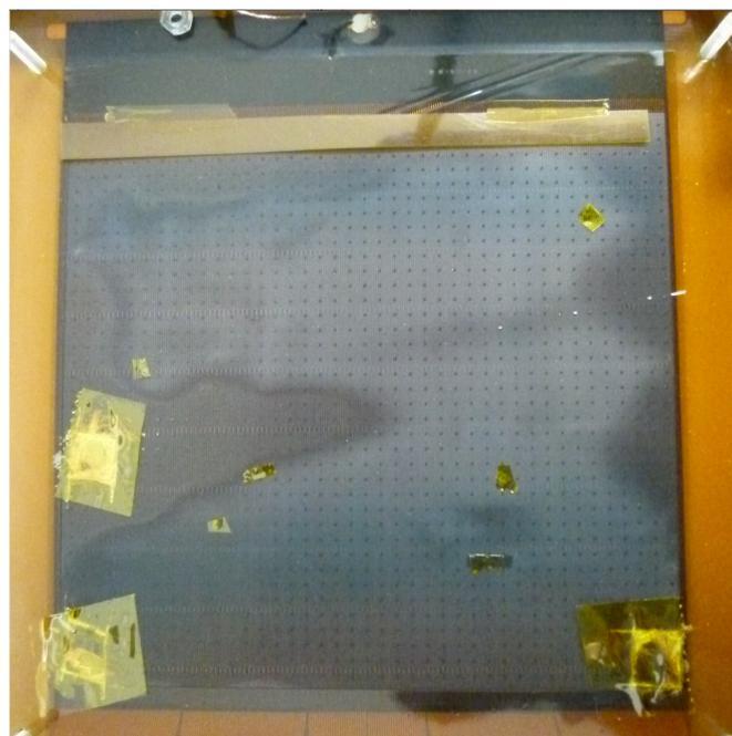
図 7.9 照射後の J31 の表面：図 7.8 の Efficiency Map と比べ、黒色領域で検出効率が低いことがわかる。
