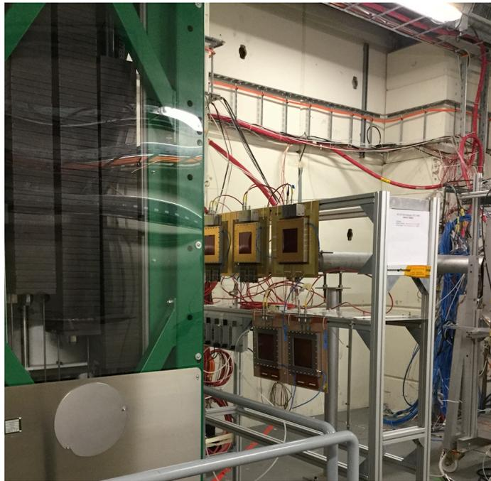
図 6.3 GIF++照射試験セットアップの写真：緑色の領域に線源が格納されている。検出器は線源から 1 m の距離に設置してある。
