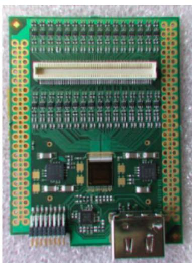
図 5.3 APV25：測定に用いたフロントエンドチップである。位置・時間の 2 次元で電荷情報を読み出す。
