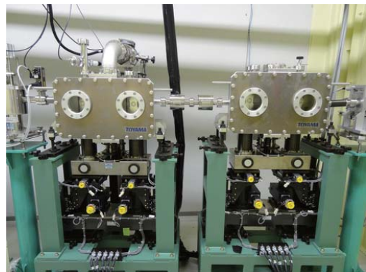
図 2.13 (左) 全反射ミラーの概略図, (右) 写真.
