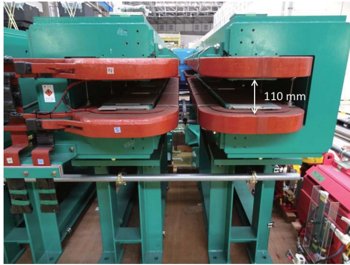
図 5.2 KEKB の常伝導双極子電磁石の写真.
