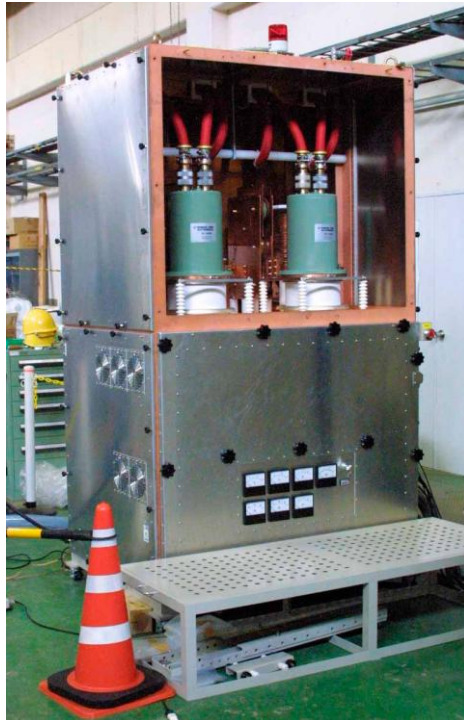
図 3-10 : 1.2MW プッシュプルアンプ
