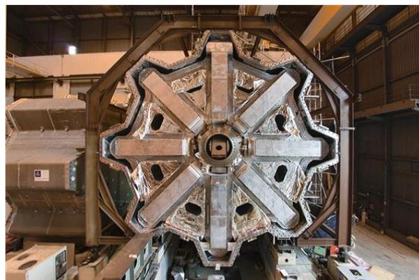
図 3.33: troid 磁石 (endcap 磁石)
