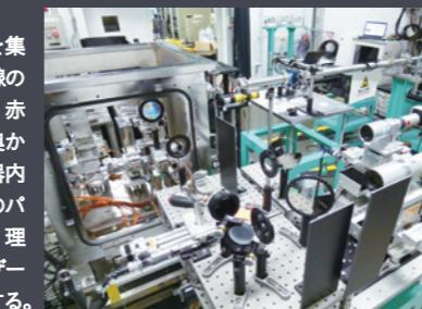
大強度赤外線レーザーを集中させて真空を歪め、X線の散乱で歪みを検出する。赤外線レーザーは写真左奥から供給され、四角い容器内で集中させる。X線は右のパイプから送られてくる。理研の「X線自由電子レーザー施設 (SACLA)」を利用する。
