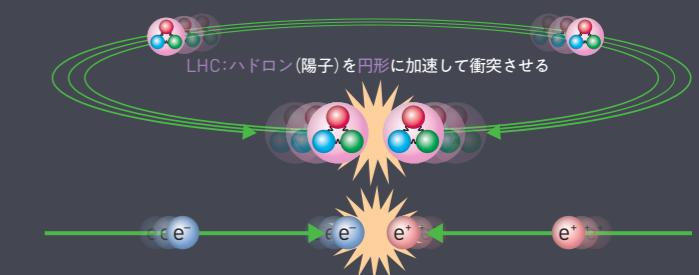
LHCとILCの加速器の性質の違い。ILCは、単体の素粒子（電子と陽電子）を衝突させるため、素粒子の詳細な性質を調べるために適している。
