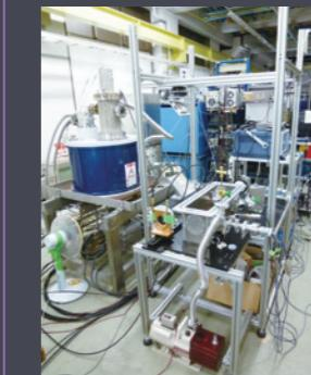
高出力サブテラヘルツ波光源-ジャイロトロン。福井大学が開発したこの装置に、浅井研究室が開発した装置を組み合わせ、ポジトロニウムの状態間のエネルギー差を世界で初めて観測することに成功した。
