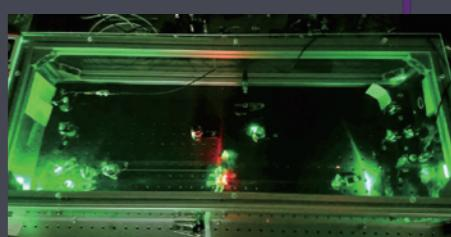
ポジトロニウム冷却用レーザーの生成装置。光共振器と増幅器、変調器を組み合わせ、特殊なレーザー光をつくり出す。後段に多段増幅器と波長変換装置を組み合わせ、ポジトロニウム冷却光源として利用する。
