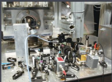
強磁場による真空の歪みを探索する装置。強磁場中を通してわざわざ偏光が変わった赤外線レーザーが、左奥の丸い窓から出てくる。手前に配置された光学素子でその微小な変化を検出する。
