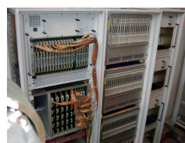
トリガー回路（上）と波形デジタル回路（右）。
