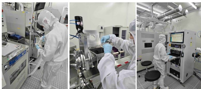
写真 2：沖縄科学技術大学院大学のファブリケーション施設にある斜め蒸着装置を使った超伝導量子ビットの製作風景
