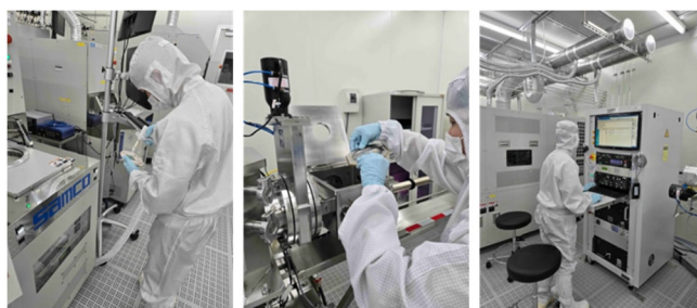
写真 13：OIST のファブリケーション施設にある斜め蒸着装置を使った超伝導量子ビットの製作風景
