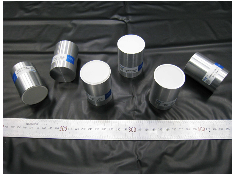
図 3.19: \text{LaBr}_3(\text{Ce}) シンチレータ。プロトタイプ測定では、直径 1.5 インチ、長さ 2 インチの \text{LaBr}_3(\text{Ce}) シンチレータを 6 個使用した。
