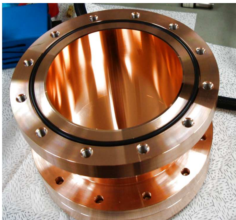
図 3.14: RF キャビティ。内部は、直径 128 mm, 長さ 100 mm の円柱形。共振モードは TM_{110} モード。固有周波数は 2.8566 GHz , Q_L = 14700 .
