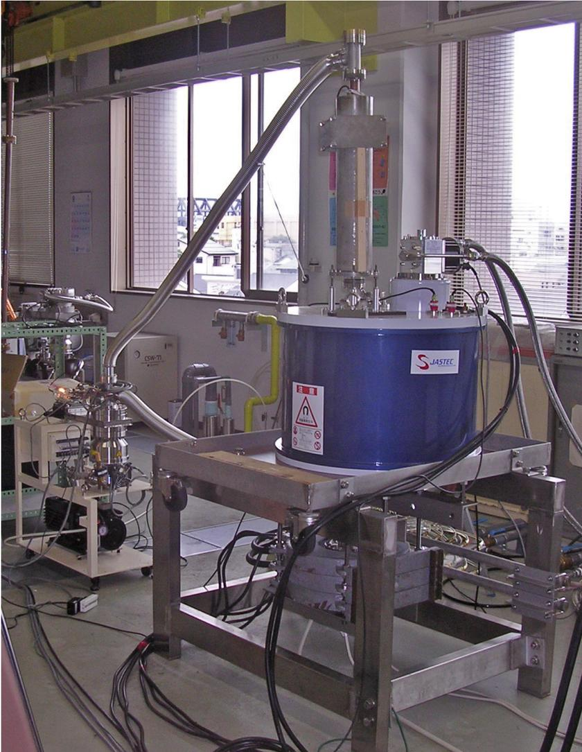
福井大遠赤センターと共同で開発しているジャイロトロンを用い、203GHz, 100Wの大強度サブテラヘルツ波でHFSを直接遷移させて測定。
