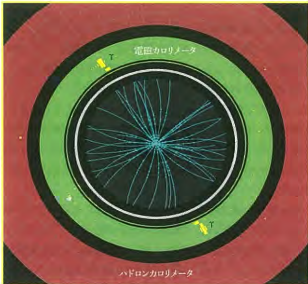
図8 観測された事象の例。H → γγ 事象の候補。中央の飛跡検出器で観測されている粒子は、エネルギーの低いヒッグス粒子生成とは無関係の粒子である。
